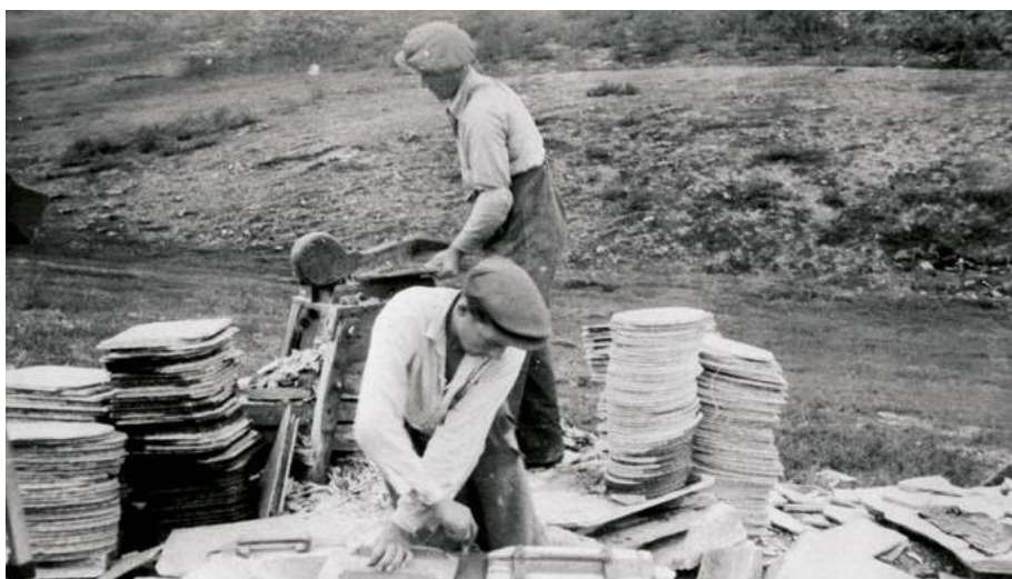
Tillitsfullt samarbeid. Morten Skaslien svinger slegga mens faren hans, skifergründer Olaf Skaslien, holder meiselen og er klar til å dele skiferblokken.
